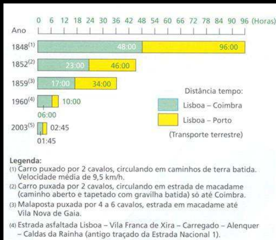
Fig. 1 Distância-tempo Lisboa-Coimbra e Lisboa-Porto (transporte terrestre: da terra batida à autoestrada e da diligência ao automóvel)
