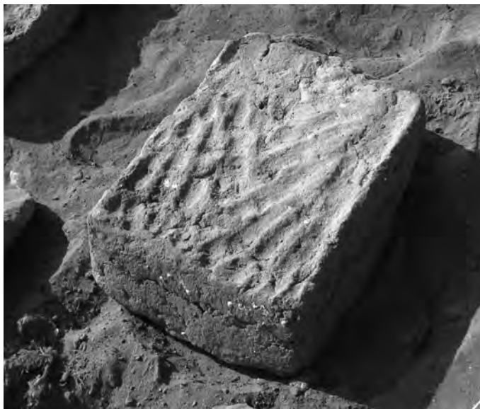
Figura 3: Adobe precolombino con huellas de manos. Dimensiones aproximadas: 30 cm x 20 cm x 12 cm. Fuente: Fotografía del autor.
