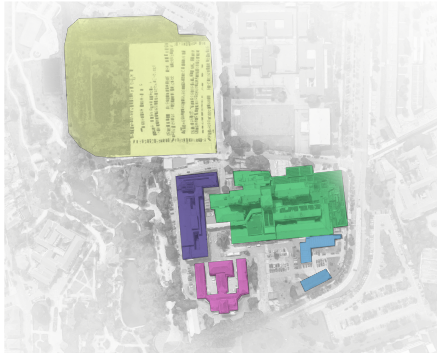
Ilustración 33. Hospital Infante D. Pedro. Análisis y división de bloques por antigüedad. En rosa, primer edificio construido; en verde, segundo bloque construido; en violeta tercer bloque construido y en azul últimos prefabricados añadidos. En amarillo se identifica la ubicación del proyecto de ampliación. Realizado por Laura Castro por medio de una fotografía satélite de Google Maps.
