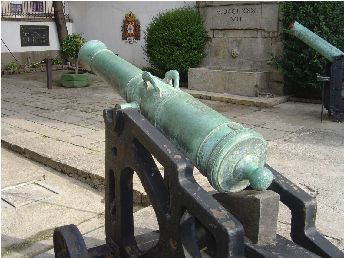
Figura 56. Vista posterior de peça de campanha de 9 libras em reparo descontextualizado, Arsenal Real do Exército (1802) – Foto: Sérgio Veludo Coelho/Museu Militar do Porto.
