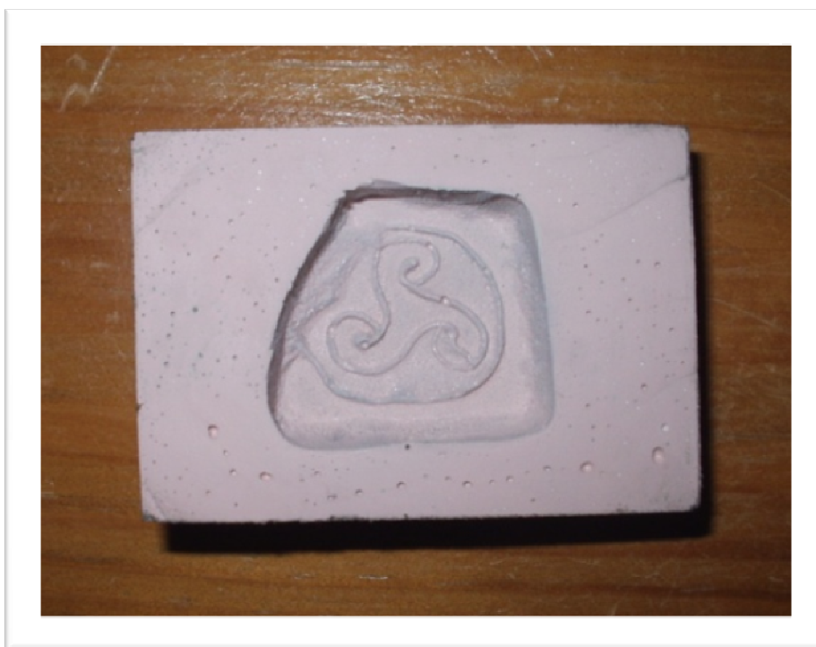
Foto 26 – Molde de borracha univalve.
