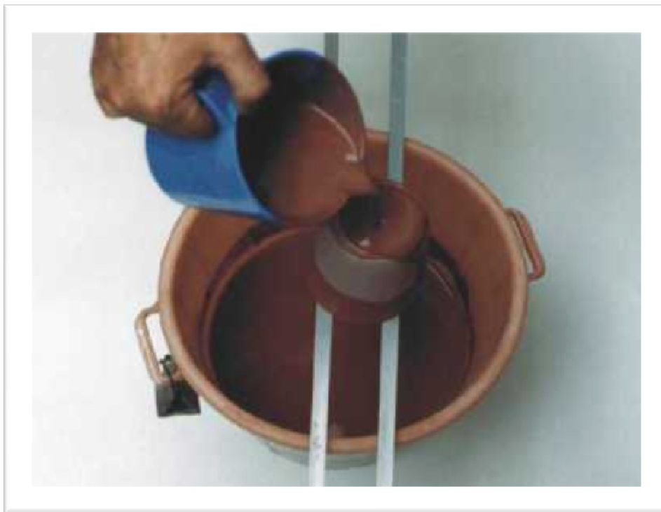
Foto 17 – Aplicação do esmalte por derramação
