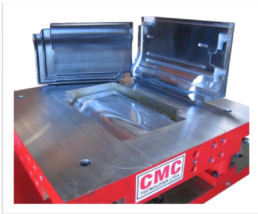
Foto 11 – Matriz para prensagens de telhas em prensa hidráulica
