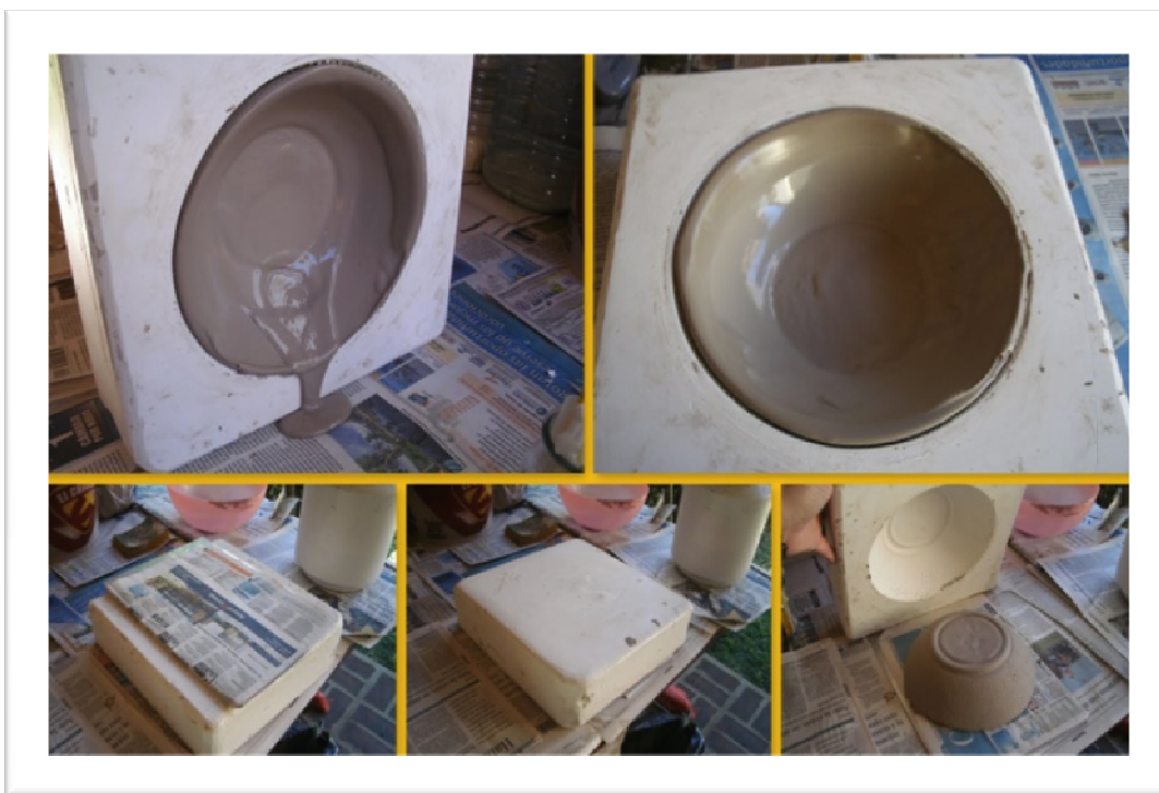
Foto 10 – Verter cerâmica líquida (barbotina) em molde de gesso
