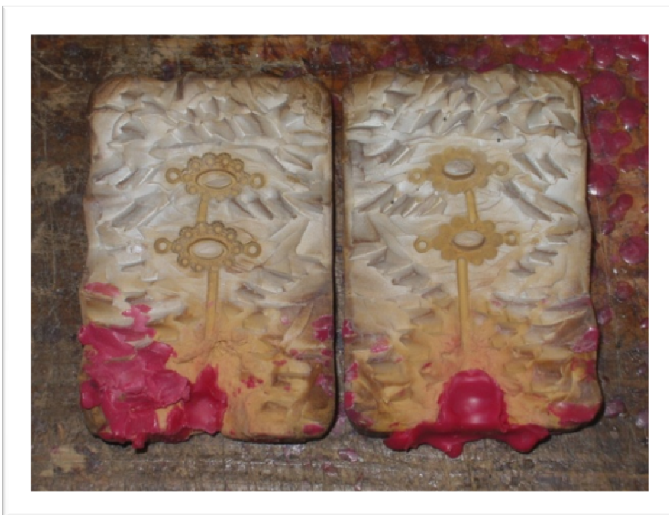
Foto 38 – Molde em borracha vulcanizada a quente
