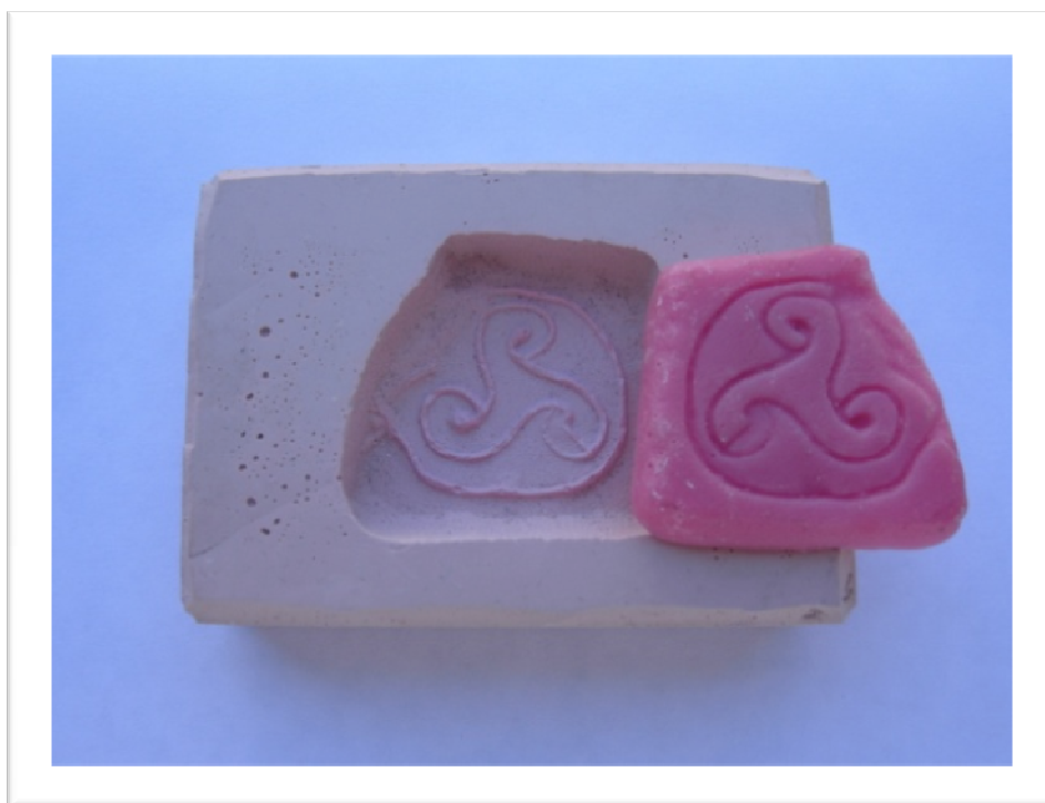
Foto 40 – Molde em borracha e matriz do trísceles de Favais em cera (após verter a cera derretida e arrefecimento)
