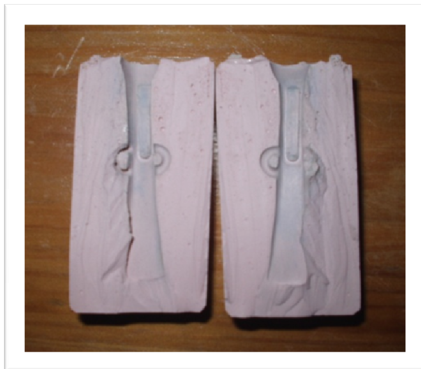
Foto 27 – Molde de borracha bivalve
