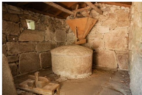
Fig. 158 – Maquinaria interior dos muíños.
