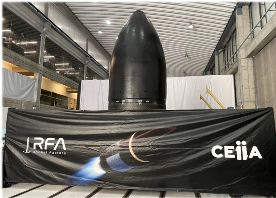
Figura 25 Payload fairing desenvolvida entre a RFA e o CEiA antes de ir para o local de lançamento em SaxaVord Fonte: www.ceia.com , 2024
