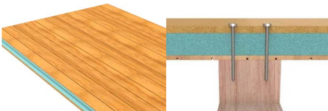
Figura 60 Panel sándwich acabado madera friso abeto y detalle de la unión.
