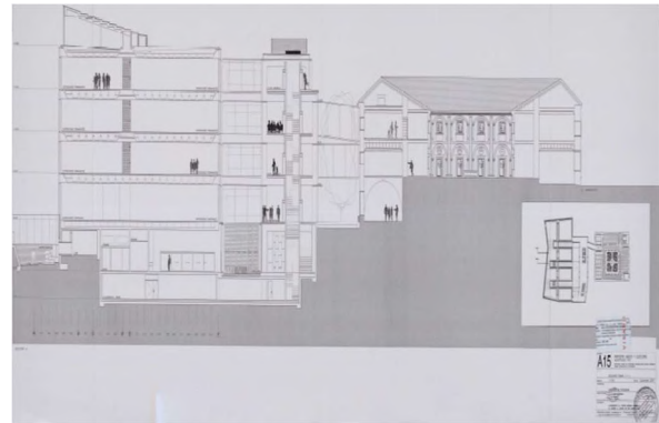
Figuras 176-177-178-179. Planos LA01-LA03-A13-A15 del estado modificado, fachadas y sección constructiva con edificio ampliación.
