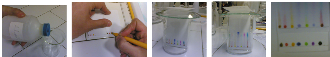
Fig.1. Sequência experimental do estudo das cores primárias e secundárias por cromatografia em papel.
